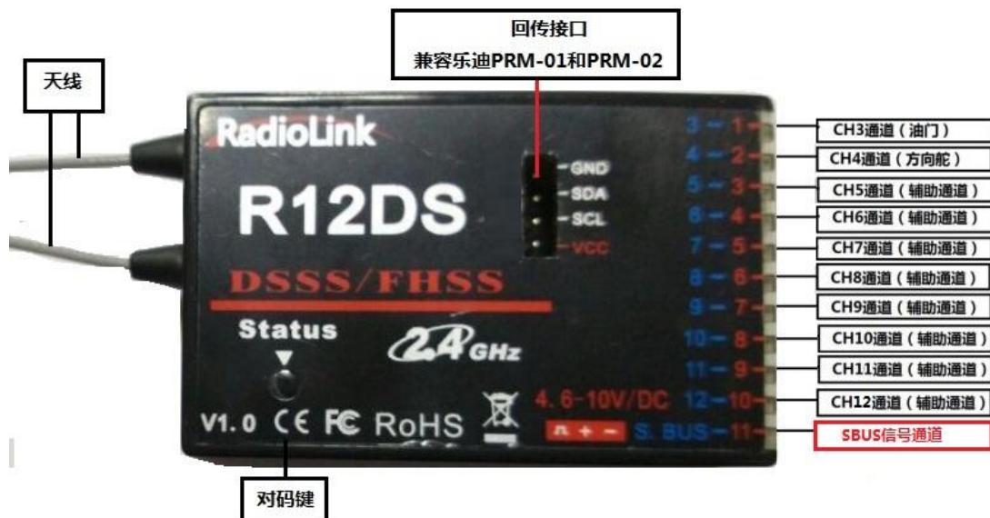
SBUS信号模式，蓝色/紫色指示灯，输出12个通道的信号
