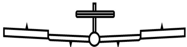
空气刹车/蝶式混控状态下，飞机舵面示意图（2A+2F）
