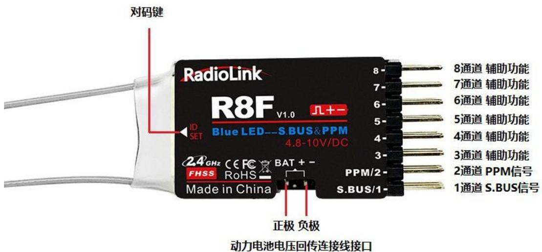
此模式下，一秒内短按对码键两次，将接收机红色指示灯切换为蓝色指示灯，可将 R8F 由标准 PWM 信号工作模式切换为 SBUS/PPM 信号模式。
